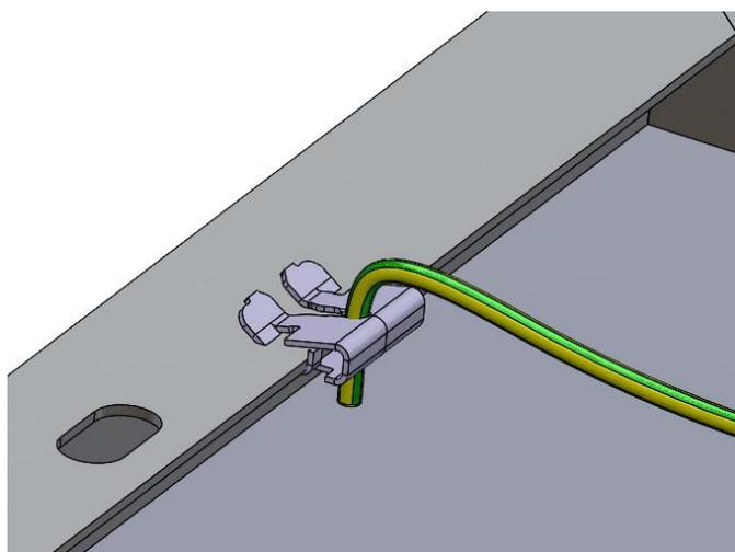
Insérer l'attache sur le retour de cadre du module
