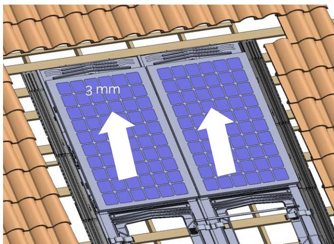
Positionner le module sur la butée du cadre puis remonter le module de 3 mm
