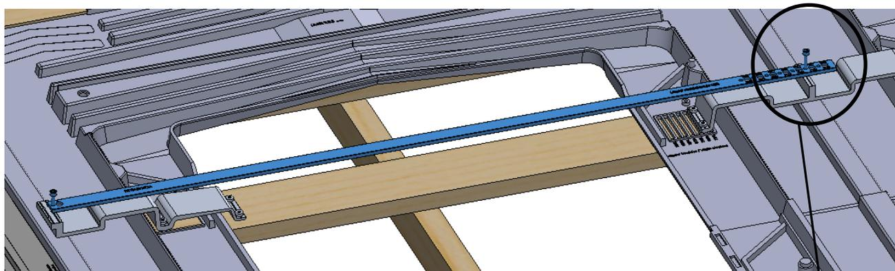
Utiliser les piges de montage pour garantir le bon espacement des pattes. Utiliser la vis de bride.
