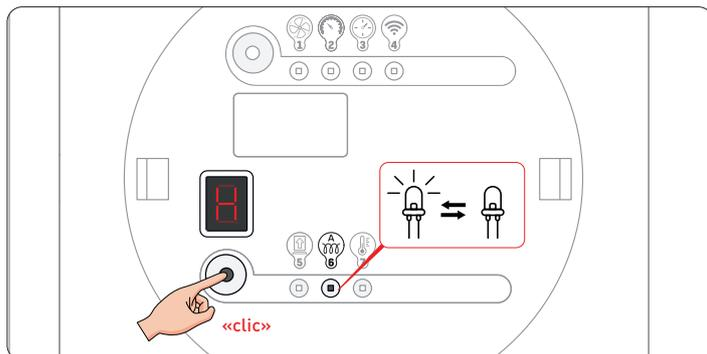
7. Comme précisé au point 3, cliquez sur le bouton inférieur jusqu'à atteindre le réglage de la batterie de préchauffage.
