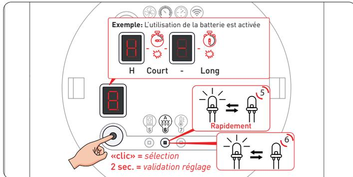
5. Cliquez sur le bouton inférieur pour modifier le paramètre du sous-réglage.
