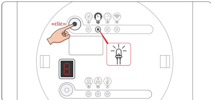
1. Appuyez brièvement sur le bouton supérieur jusqu'à ce que la LED correspondant au réglage du débit d'air variable et l'afficheur 7 segments s'illuminent.
