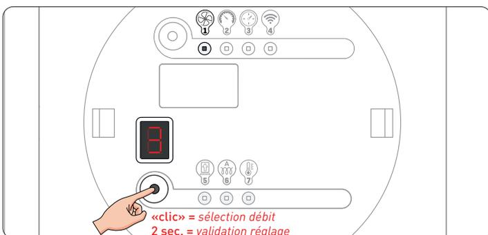
5. Appuyez brièvement sur le bouton inférieur pour choisir le régime de fonctionnement correspondant au logement (voir le tableau de réglage du débit ci-dessus).
