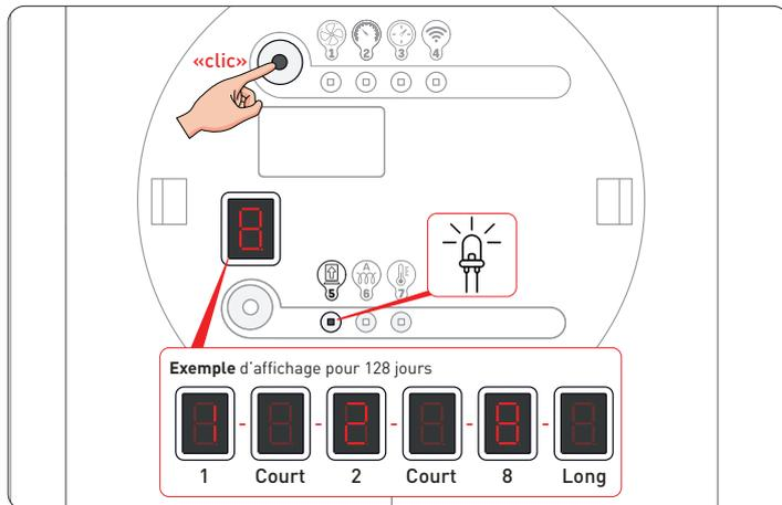
1. Appuyez brièvement sur le bouton supérieur jusqu'à ce que la LED correspondant à la temporisation filtres et l'afficheur 7 segments s'illuminent.
