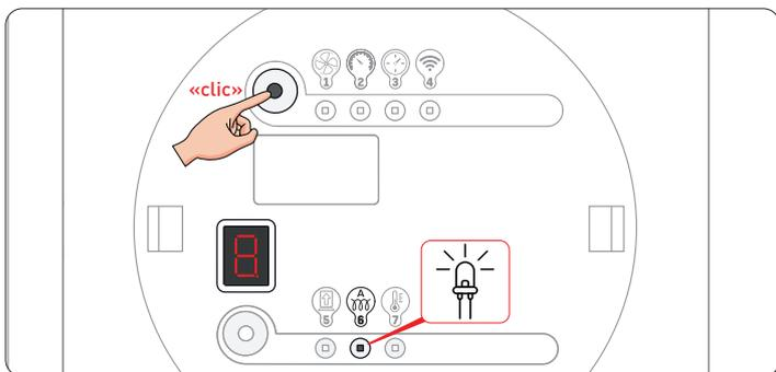
1. Appuyez brièvement sur le bouton supérieur jusqu'à ce que la LED correspondant aux réglages avancés et l'afficheur 7 segments s'illuminent.
