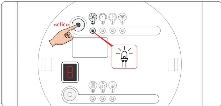
3. Appuyez brièvement sur le bouton supérieur jusqu'à ce que la LED correspondant au réglage du débit et l'afficheur 7 segments s'illuminent.
