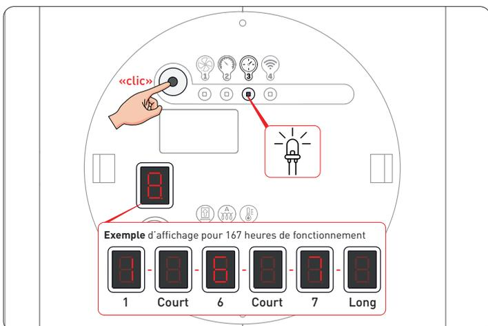
Appuyez brièvement sur le bouton supérieur jusqu'à ce que la LED correspondant au réglage du débit d'air variable et l'afficheur 7 segments s'illuminent.
