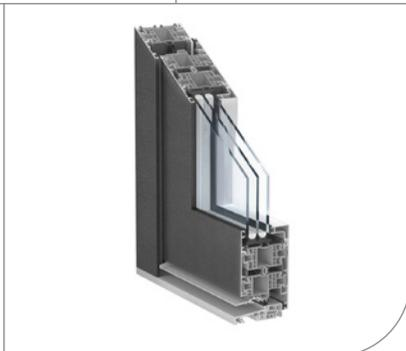
76 mm WarmCore® est un système hybride innovant signé Kömmerling, associant un noyau PVC recyclé à des parements intérieurs et extérieurs aluminium. Conçu pour être soudé sur une ligne standard, il simplifie la production sans renfort ni usinage supplémentaire. Sa conception optimise les coûts, les temps de fabrication et garantit une solution performante, durable et adaptée aux exigences industrielles.
