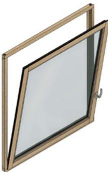
Dormant de 48 mm, vitrage sous vide, épaisseur 8 mm, ferrage invisible à 180 degrés d'ouverture, résultat thermique UW < 1.00 Classement A\*4 - E\*7B - V\*C2.
