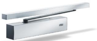
Ferme-porte en applique GEZE TS 7000 X DC avec technologie Easyflow, une efficacité de plus de 80 %, un système hydraulique adaptatif (SensiStop et SensiLatch), un retard à la fermeture et un bras à coulisse standard réglable.
