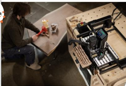
BenchPilot est monté sur Workstation ou directement sur la surface de travail et forme un système qui ressemble à un portique. Il est ainsi possible de réaliser non seulement des usinages de surface, mais aussi des usinages sur chants, comme le fraisage d'inserts, de gravures délicates ou de profilés. Idéal pour la production en série ou les travaux de longue haleine
