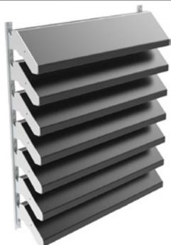
Bardage ventilé acoustique avec lames aux pas de 150mm sur mesure pour une atténuation acoustique de 11dB(A).
