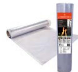
BLOCKFLAM 430 est un écran pare-pluie nouvelle génération à la fois résistant aux flammes et réflecteur de chaleur pour les façades et toitures ventilées. Il améliore le confort d'été en luttant contre la surchauffe des combles en limitant l'échauffement des bois de charpente et de l'isolation de 60%. Sa haute perméance à la vapeur d'eau évite la condensation dans les parois. Non combustible, il répond aux exigences en ERP (IT249, DTU 24.1).
