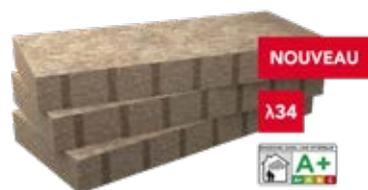
Mb Rock Premium est conçu pour l'isolation entre montants des constructions à ossature bois. Il garantit un calme absolu à l'intérieur du logement et protège des nuisances sonores extérieures. Excellentes performances thermiques et acoustiques : Excellent confort d'été. Installation facile : pas de découpe, bord flexible Adapté aux espaces courants entre montants Masse volumique nominale : 65 kg/m<sup>3</sup> Réaction au feu : A1
