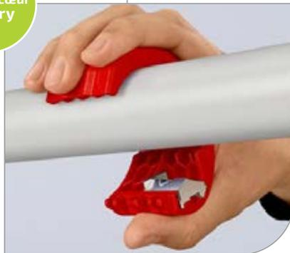
Coupe-tube PVC grande capacité - ultra compact - diamètre de coupe : de 20 à 50mm. Coupe nette, rapide, droite et sans bavure. Pas de copeau. La chute du tuyau reste dans le coupe-tube évitant ainsi sa chute sur le sol. Très compact. Tient dans la poche. Système de fermeture sous forme de coquille évitant tout risque de blessure. PVC, tuyaux évacuation PVC-U, Gaines IRL, etc. Livré avec 2 lames de rechange. Made in Germany
