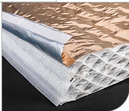
HYBRIS est un isolant alvéolaire 3 en 1 de nouvelle génération qui assure l'isolation thermique hiver/été, l'isolation phonique et l'étanchéité à l'air. Il est composé d'une structure en "nid d'abeilles" exploitant les qualités thermiques d'un isolant naturel très efficace : l'air.
