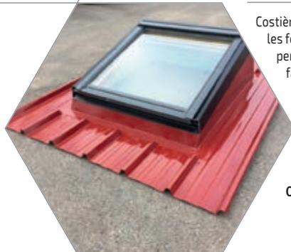
Costières monobloc en résine polyester et fibre de verre, isolées, pour adapter les fenêtres de toit de type Velux sur un toit bac acier. Permet de relever la pente de la fenêtre pour être en conformité avec les préconisations du fabricant de fenêtres. Fournies avec le raccord d'étanchéité. Fabrication à la couleur suivant référentiel RAL.
