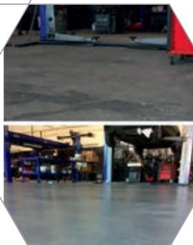
La solution CHRYSO®HardTopping permet aux dallagistes de rénover eux-mêmes, facilement, en cadence industrielle et à moindre coût une dalle industrielle défectueuse. CHRYSO®HardTopping offre un aspect, un toucher et des finitions proches d'un dallage industriel classique.
