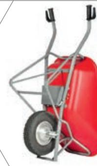
Brouette à assistance électrique, ultra résistante (caisse PEHD de 7mm d'épaisseur) avec batterie lithium ion de 42V5a, roue increvable, avec moteur intégré dans la roue.
